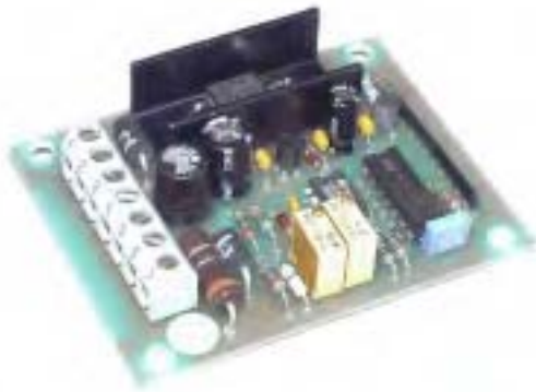
Verstärkerplatte für 1 Proportionalmagnet Plaque-amplificateur pour 1 aimant proportionnel
